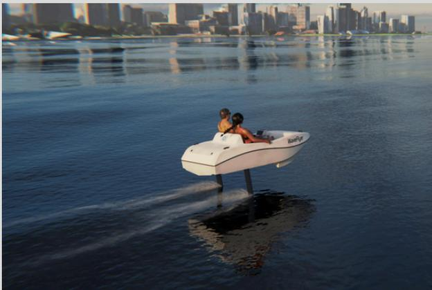
Ces hydrofoils sont des ailes sous-marines contrôlées de façon autonome par ordinateur qui permettra au bateau de s'envoler au-dessus de l'eau.
